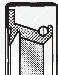
WBT se šroubovicí pro zpětnou dopravu doleva a pracho vým břitem
