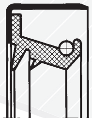
WBV se dvěma prachovými břity
